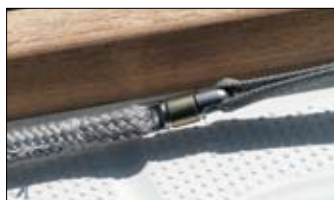
▲ La sangle passe dans des poulies « ordinaires » ; la liaison bout/sangle est assurée par un émerillon.
