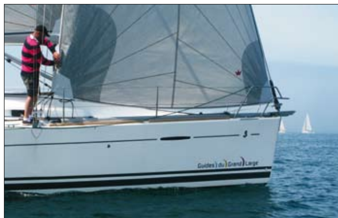
▲ Avec son tambour ultra-plat, le FlatDeck permet de gagner une bonne vingtaine de centimètres de guindant – c'est bon pour les performances !
