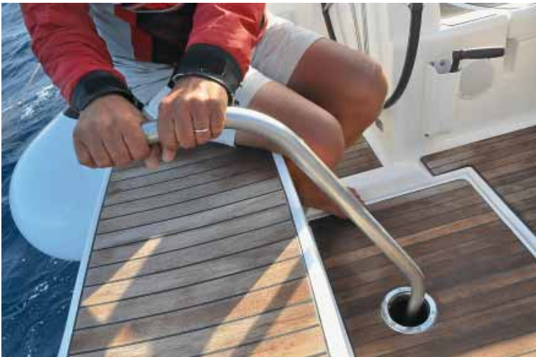
La barre de secours du bord s'utilise à l'envers d'une barre franche habituelle, ce qui a représenté un gros handicap pour les barreaux.
